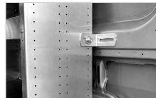
L-uholník nastavený medzi regálom a nosníkom karosérie
